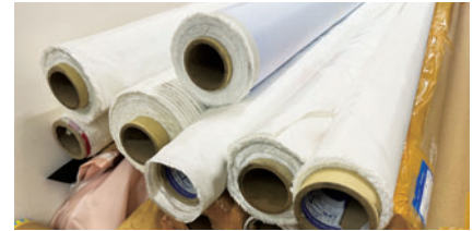
自動車の厳しい要求品質に応えるエアバッグ生地。一反(2メートル×600メートル)ごとに検品します
